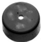
Defekte Dichtung Defective seal Junta defectuosa Joint défectueux
