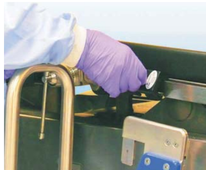
Foto 4 Collegamento del morsetto per guide alla guida
