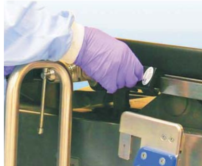
Resim 4 Ray Kelepçesinin Raya Takılması
