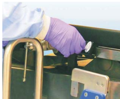
Photo 4 Fixation de l'étau sur le rail
