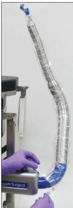
Foto 3 Abdeckmaterial vollständig auf dem Arm des ALLY UPS® nach unten gezogen
