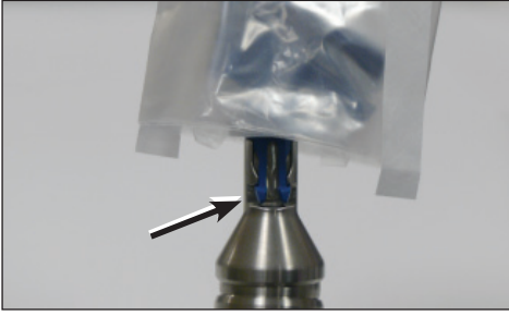
Resim 2b Oturmuş Pozisyondaki Sıkıştırma Klipsleri
