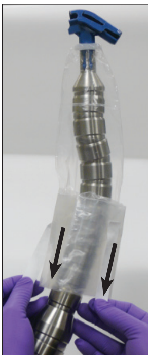
Foto 3b Abdeckmaterial teilweise nach unten gezogen
