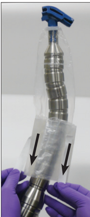
Foto 3b Beschermhoes gedeeltelijk omlaag getrokken
