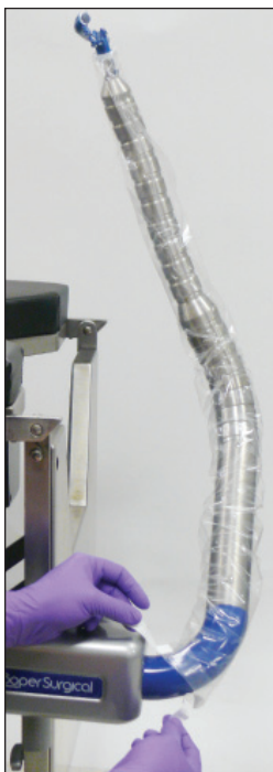
Foto 3 Onderkant van de beschermhoes volledig over de ALLY UPS® arm getrokken
