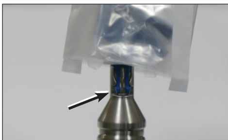
Foto 2b Fermagli in posizione inserita
