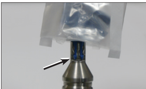
Photo 2b Clips-pinces en position
