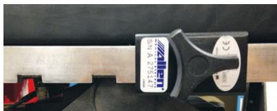
Figure 2b : Déplacement de l'étau vers la droite à l'écart des fentes sur le rail
