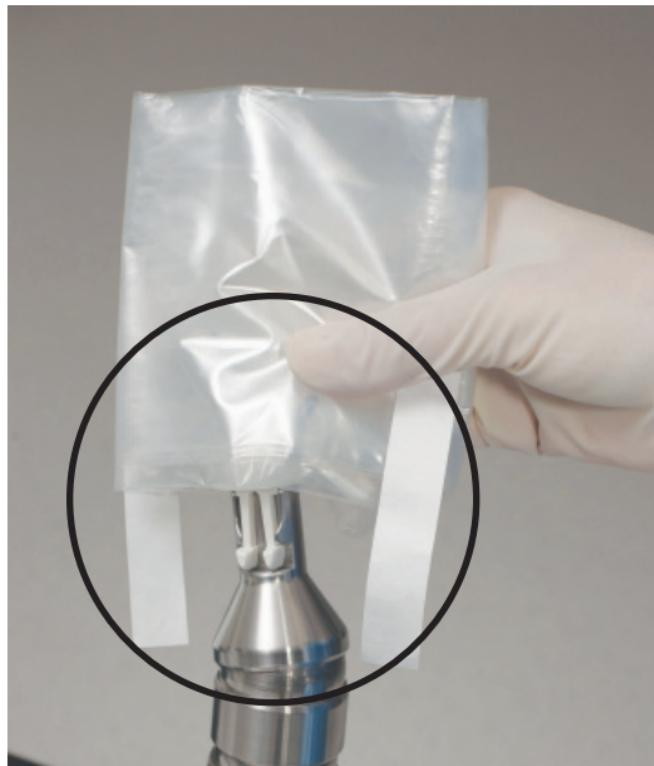
**Foto 3b** Befestigungsclips in der eingerasteten Position
