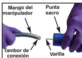
1. Sujete la punta sacro con una mano y el extremo del mango del manipulador con la otra. Alinee la varilla (situada en el extremo de la punta sacro) con el orificio final del tambor de conexión e insértela.
