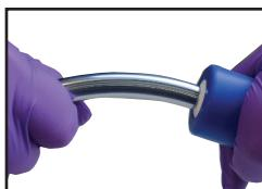
4. Un leve tirón en la punta le permitirá verificar que está firmemente sujetada.
