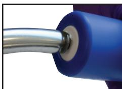
3. Inspecter visuellement pour veiller à ce que l'embout soit enfoncé à fond dans et autour du cylindre à enclenchement à pression.
